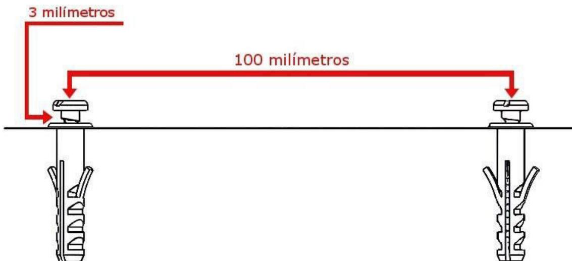
Na parte posterior do equipamento existem três orifícios para encaixe do Marque Ponto (ver capítulo “Visão Geral do Equipamento”).
