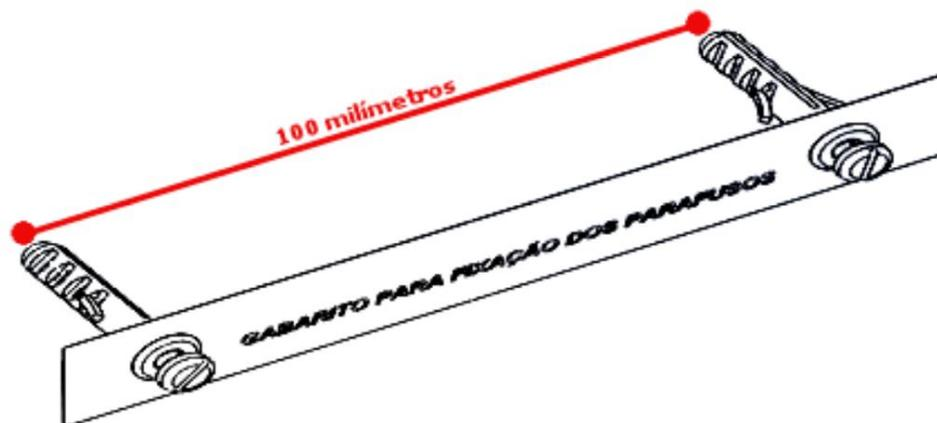
Após a introdução das buchas, rosqueie os parafusos deixando uma folga mínima entre a flange da bucha com a cabeça do parafuso de 3 milímetros.
