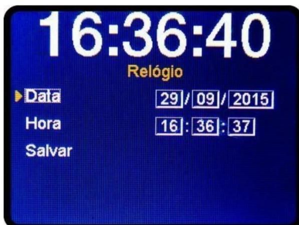
Neste menu é possível configurar a data e hora do equipamento. Lembrando que toda modificação de horário será registrada no equipamento e armazenada de maneira permanente na memória de registros do equipamento, juntamente com os dados do operador que realizou a alteração.
