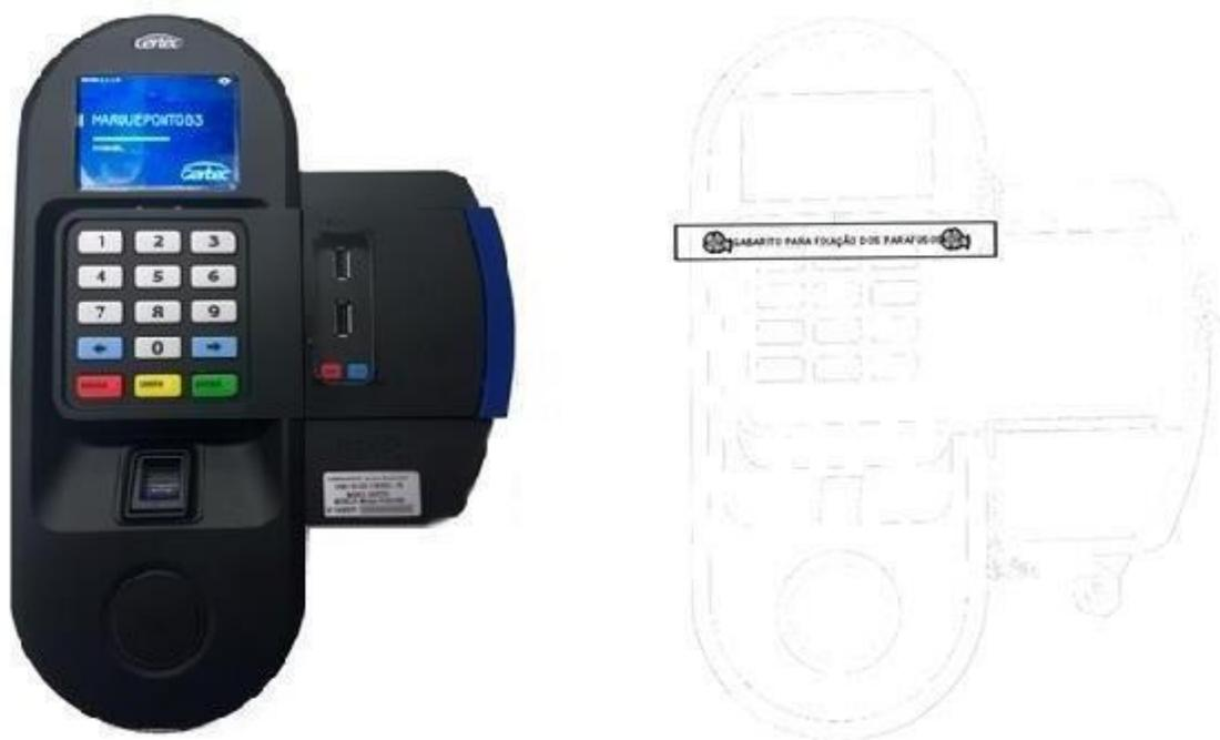
Utilize o auxílio do próprio equipamento para marcar o local do furo, inserção da bucha e parafuso.
